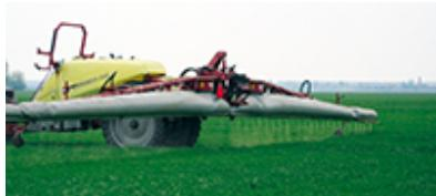
Koristi se za potpuno pokrivanje biljne mase otopinom pesticida, a osobito s donje strane lista, što i dalje ostaje problem u zaštiti bilja. Obilježja ove tehnike su velika količina zraka (4000 – 6200 m<sup>3</sup>/h) dobivena ugradnjom zračnog ventilatora; zračne sapnice kojima se ostvaruje brzina zraka oko 45 m/s; proizvodnja sitnih kapljica korištenjem sapnica sa šupljim konusnim mlazom.
