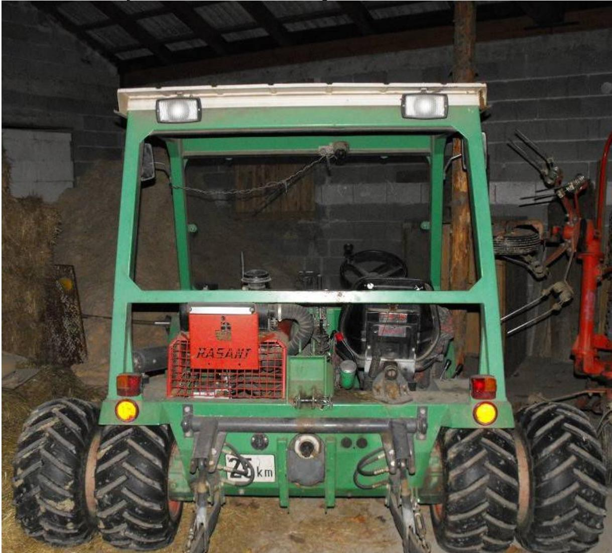
Na strminama do 50% nagiba (obrađena tla) odnosno 60% (zeleni pokrov) mogu se strojno obrađivati kao nasadi na blagom nagibu, ali traktorima nešto veće širine i sniženog težišta. To se postiže još širim pneumaticima, gumenim gusjenicama kod jednoosovinaca i nešto promjenjenom konstrukcijom podvozja (slika 3).
