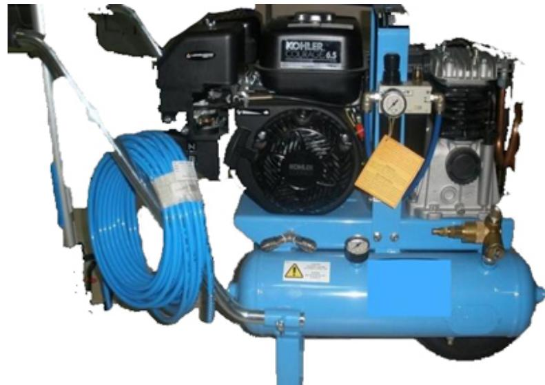
*Motorni kompresor sa opremom – tresač maslina*
