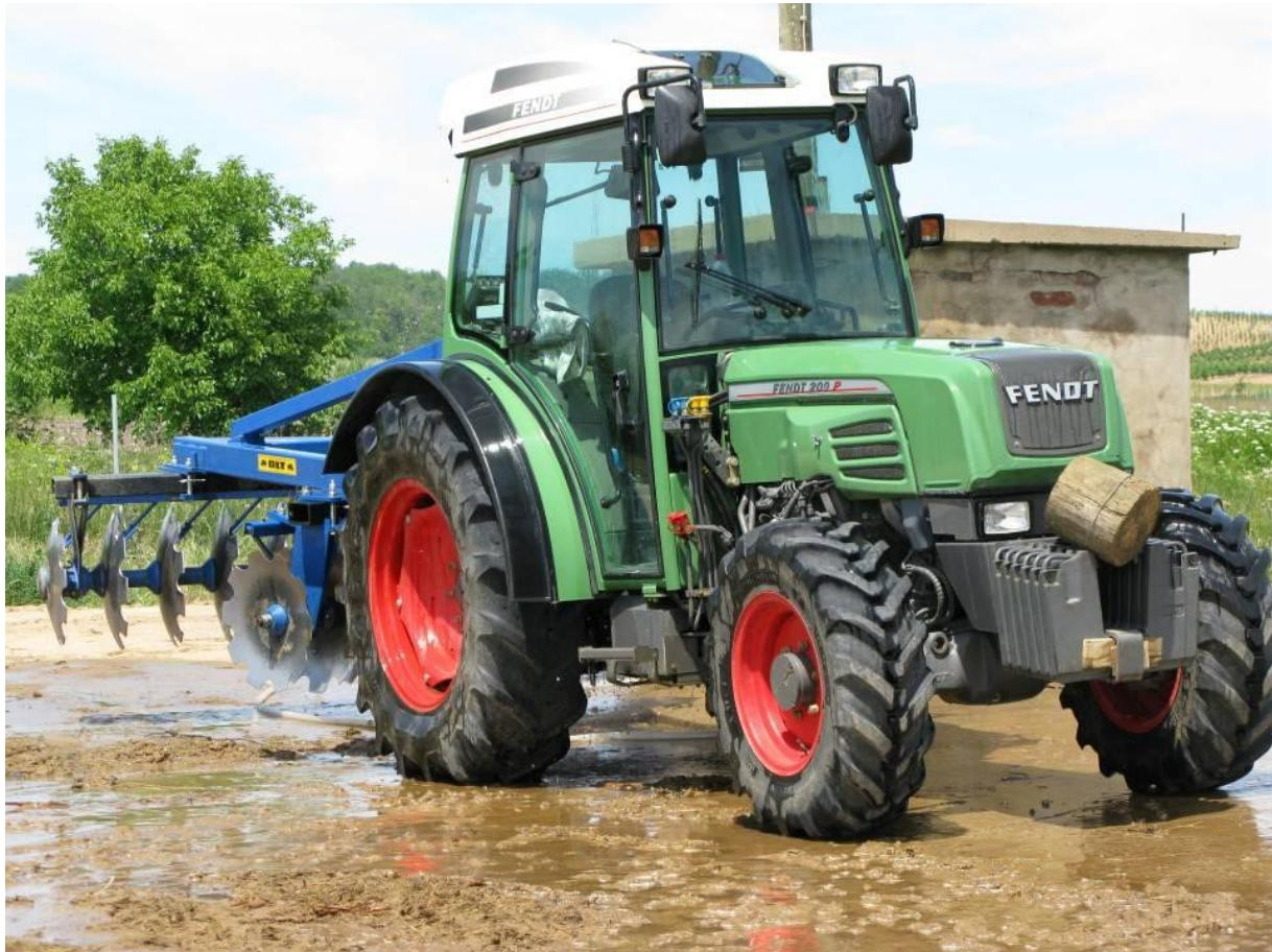
*Vinogradarski traktori – uže izvedbe, relativno nisko težište, mogućnost ostvarivanja većih vučnih sila.*
