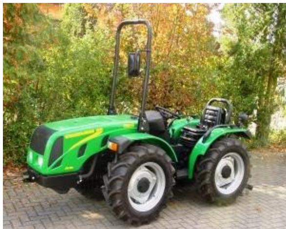
*Transportni traktori* – mogućnost ostvarivanja veće brzine kretanja (80 km/h) i promjene stupnja prijenosa u vožnji, moraju imati pneumatski uređaj za kočenje prikolice.
