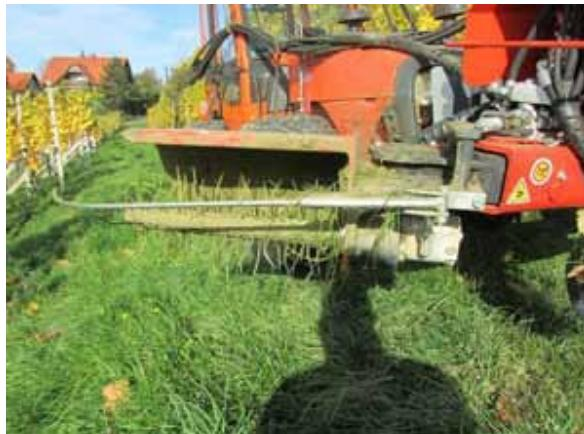
Princip rada malčera s užetom temelji se na sjeći biljaka pomoću užeta, koje je izrađeno od PVC, gume ili metala. To znači da se pojas ispod stabla obrađuje samo površinski, bez upotrebe noževa. Horizontalni nosač opremljen je približno 50 cm dugom metalnom osovinom na kojoj se s vanjske strane nalaze žice. Na gornjoj strani montiran je štit koji sprečava oštećenja donjih grana i plodova od prljavštine. Osovina se pokreće pomoću hidromotora, a radna brzina stroja iznosi do 8 km/h.
