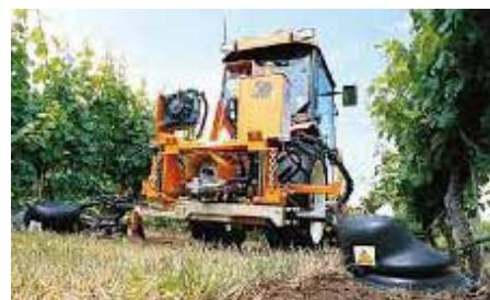
Slika 5.: Mini rotacijski noževi Pellenc Tournesol.
